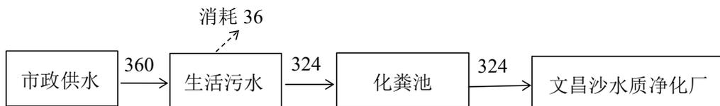
图 2-1 项目水平衡图（单位：m<sup>3</sup>/a）
